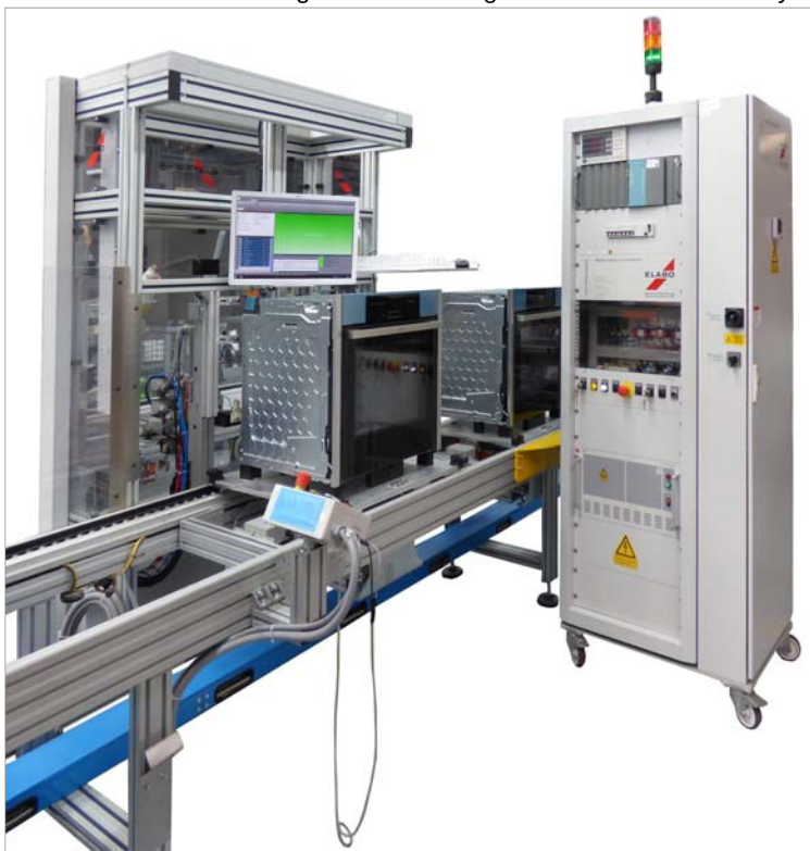
Foto 1: End-of-line Prüfung von Haushaltsgeräten mit ELABO-Prüfsystemen
